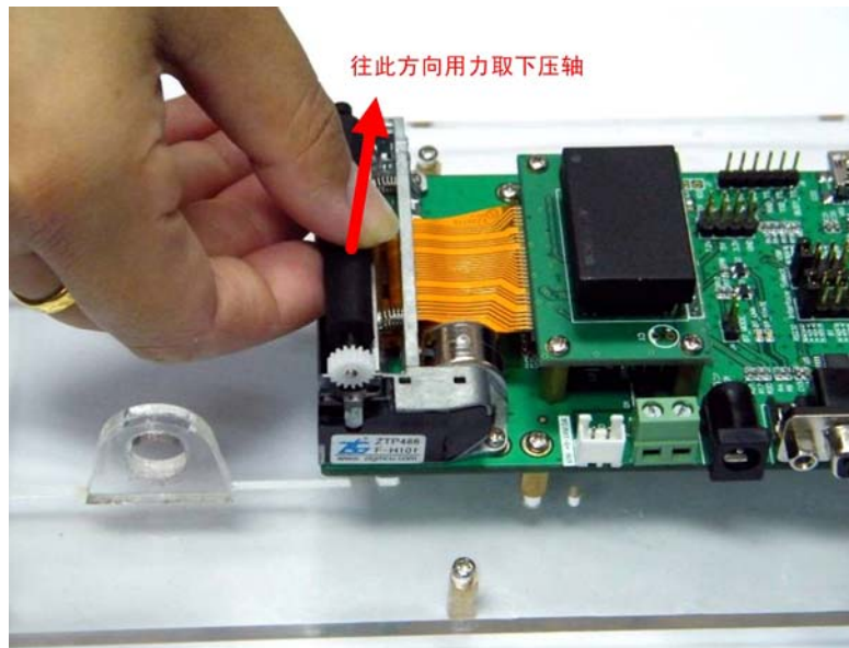
图 3.2 打开热敏打印机芯压轴
